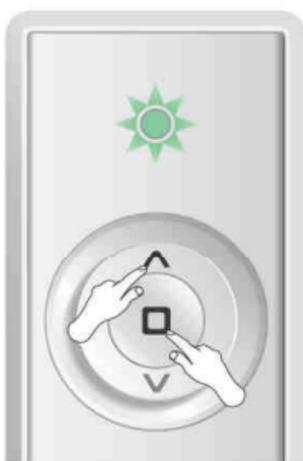
Appuyez le bouton HAUT et STOP en même temps jusqu'au moment d'entrée dans le mode de sélection de la fonction Z-Wave.
