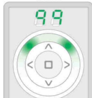
V průběhu 99 sekund aktivujte režim programování\*1 v zařízení, které má řídit jiné zařízení.
