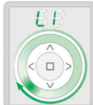
Dálk. ovladač přechází do režimu naslouchání. Zelené LED diody blikají postupně ve směru hodinových ručiček. Dálk. ovladač zůstává v režimu naslouchání po dobu 30 sekund od ukončení převodu dat.
