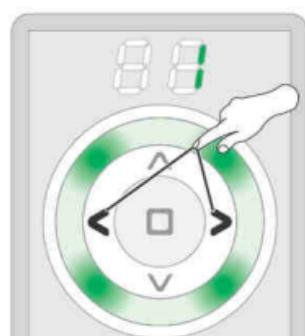
Pomocí tlačítek DOLEVA/ DOPRAVA vyberte skupinu, ke které chcete přiřadit zařízení (např. 1).
