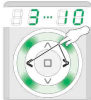
Pomocí tlačítek DOLEVA/ DOPRAVA vyberte čas, po jehož uplynutí začne markýza fungovat.
