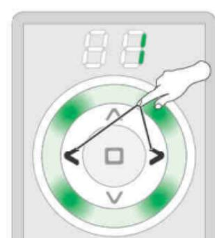
Pomocí tlačítka DOLEVA/ DOPRAVA vyberte skupinu, ke které chcete přiřadit zařízení (např. 1).
