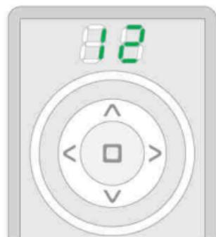
V preteklu 12 sekund vpelji odstranjeno napravo v način programiranja\*1.
