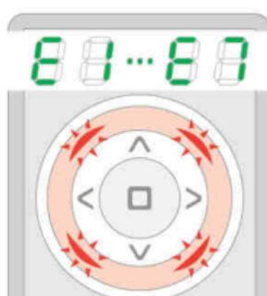
Napaka. Rdeča osvetlitev se trikrat zasveti. Ponovi proces ali glej stran 18, točko 2.
