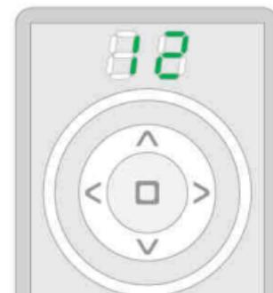
V preteklu 12 sekund vpelji dodatno napravo v način programiranja\*1.
