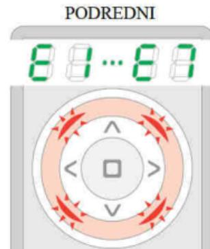
Napaka. Rdeča osvetlitev se trikrat zasveti. Ponovi proces ali glej stran 19, točko 6.
