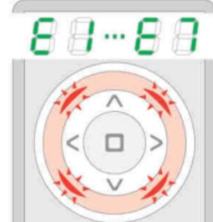
Napaka. Rdeča osvetlitev se trikrat zasveti. Ponovi proces ali glej stran 18, točko 4.
