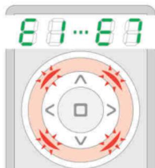
Napaka. Rdeča osvetlitev se trikrat zasveti. Ponovi proces ali glej stran 18, točko 3.
