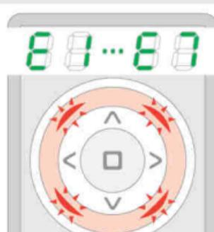
Napaka. Rdeča osvetlitev se trikrat zasveti. Ponovi proces ali glej stran 19, točko 7.
