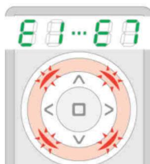
Napaka. Rdeča osvetlitev se trikrat zasveti. Ponovi proces ali glej stran 18, točko 5.
