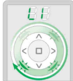
Daljinski upravljalnik preide v način monitoringa. Zelene diode LED utripajo zaporedno, v skladu s premikanjem urinih kazalcev. Daljinski upravljalnik ostane v načinu monitoringa do trenutka, ko mine 30 sekund od konca prenosa podatkov.
