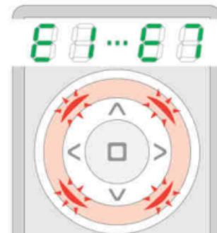
Napaka. Rdeča osvetlitev se trikrat zasveti. Ponovi proces ali glej stran 18, točko 1.
