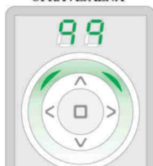
V preteku 99 sekund vnesi napravo, ki naj upravlja z drugo napravo v način programiranja\*1.
