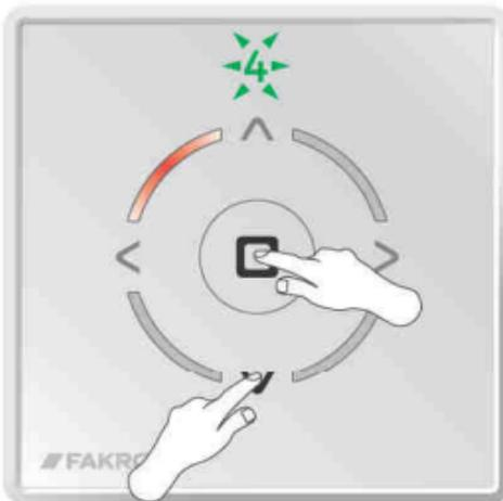
Drücken Sie gleichzeitig die Tasten OBEN und STOPP bis eine der Dioden zu blinken beginnt.
