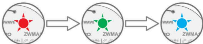
Úspěšné resetování modulu bude signalizováno postupným bliknutím všech barev na LED diodě.
