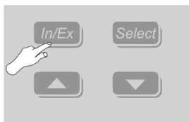
Stiskněte tlačítko IN/EX. Následně v průběhu 10 sekund stiskněte programovací tlačítko\*.
